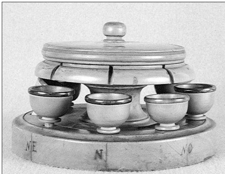
Fig.28 Sismoscopio a mercurio Cacciatore (1818). Lo strumento, progettato e fatto realizzare da Nicolò Cacciatore, direttore dell'Osservatorio Astronomico di Palermo, era ispirato ad un analogo strumento che aveva ideato, ma forse mai realizzato, l'astronomo francese Jean de Hautefeuille dopo i terremoti del 1703. L'esemplare qui riprodotto, conservato all'Ufficio Centrale di Ecologia Agraria di Roma, è uno dei due prototipi ancora esistenti; l'altro, del 1827, è conservato presso il museo dell'Osservatorio Astronomico di Palermo.
