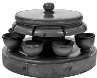
Fig. 3 – Sismoscopio a mercurio di Nicolò Cacciatori (originale conservato al CMA).
